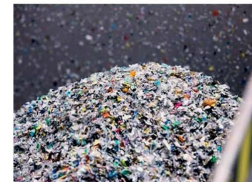
Durch verschiedene Trenn- und Reinigungsverfahren, entsteht dann schließlich ein Regranulat aus diesen recycelten und aufbereiteten Abfällen.
